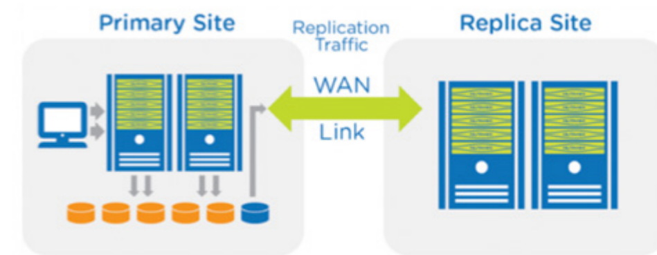
Gráfico 36: Implementación de replicación de datos entre clúster Nutanix
